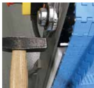
3 Tapoter doucement la tête jusqu'au verrouillage
